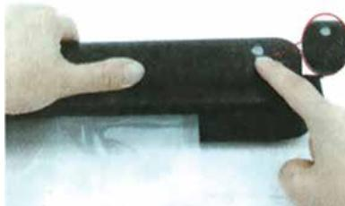
2. Bloquee los dos pestillos, presione el botón de "solamente sellado" durante 3 segundos, el indicador verde se vuelve rojo.
